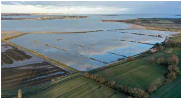
Depuis avril 2021, à partir d'un coefficient 80, la mer inonde à marée haute les anciennes prairies du polder, favorisant la restauration d'un marais maritime - janvier 2022
