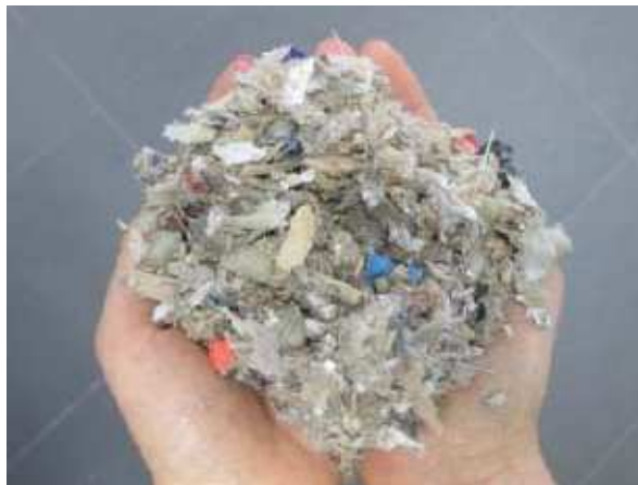
Figure 108. Le CSR, un ensemble de matériaux issus des déchets
